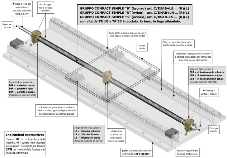
\* Per i modelli 10-12 la presa di forza è predisposta per il giunto di collegamento al motoriduttore.
