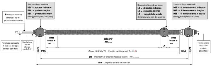
LUNGHEZZE = LB a pag. 65/M - CFS/B a pag. 65/0 - CF/FB(x2) a pag. 65/9 (normalmente l'ingombro LB viene sostituito con la lunghezza dell'intero carrello).
